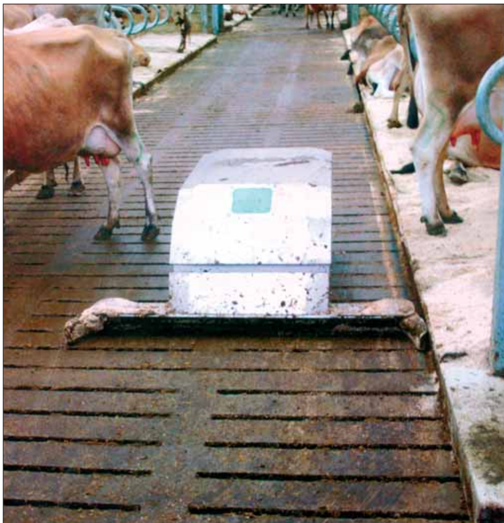
Čisté kravy: výsledok čistých uličiek po prechode neúnavného robota-zhrňovača JOZ-tech
