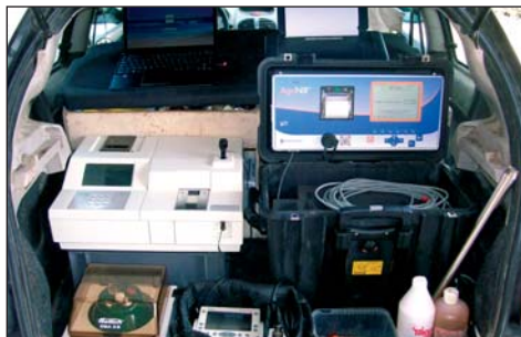
AgriNIR – prenosný optický analyzátor objemových krmív
